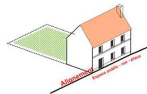
Construction à l'alignement
